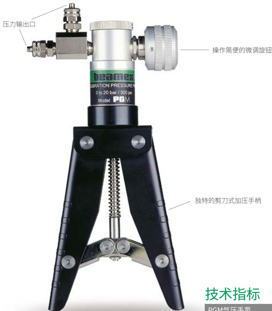
PGM手泵使用空气作为压力介质,具有精准的压力微调控制能力。独特坚固的结构,适合各种现场环境。
